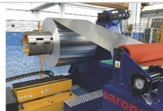
Linea di lavorazione dell'alluminio: processare tale materiale comporta notevoli difficoltà in particolare il problema dello slittamento che è stato risolto da Saronni impiegando rulli di tessuto non tessuto.
